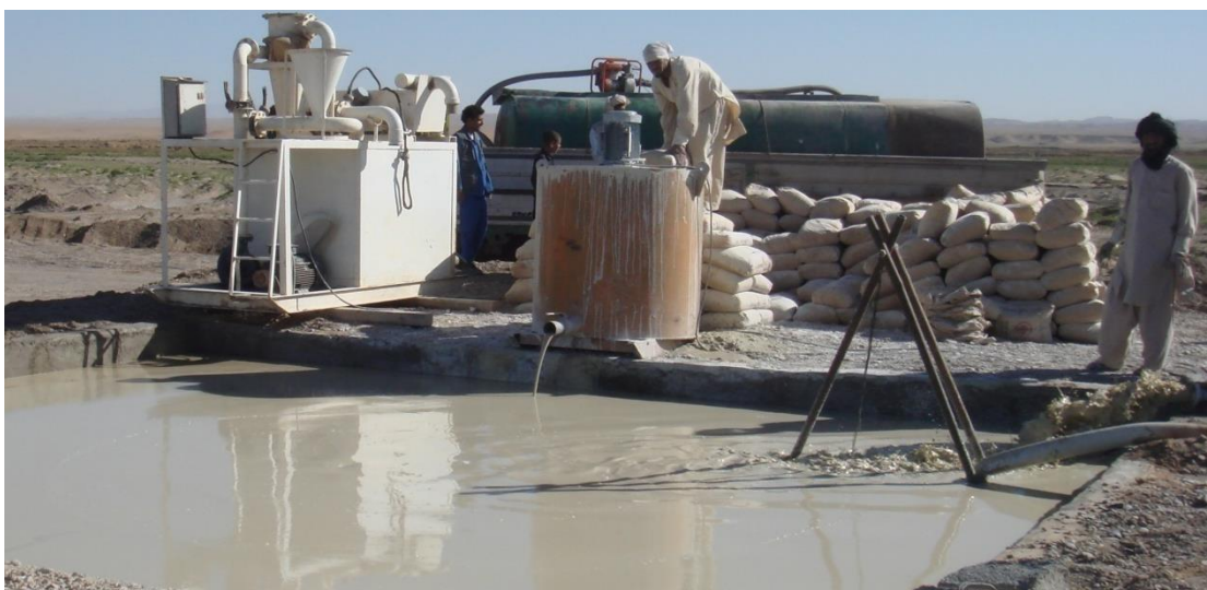
دستگاههای تولید گل حفاری و ماسه گیری
